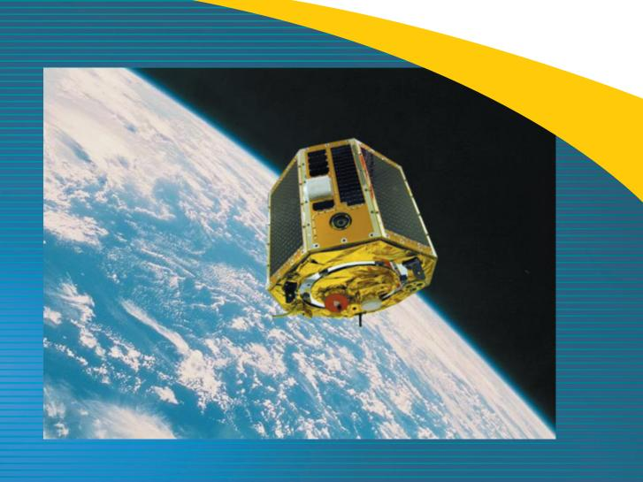
μ-LabSatなどの小型研究衛星は、宇宙機をより小型高機能化することが目的の衛星です。小型衛星は、短期間に安価な経費で、新規に開発した宇宙機用機器・部品の実験や実証ができます。このような技術実証を積み重ね、宇宙機の小型高性能化が進むものと期待されています。近年は、国内外のロケットにピギーバック衛星(ロケットの余剰能力を活用して相乗りさせた小型副衛星)として小型衛星を搭載する機会が増加しており、小型衛星に関する役割も注目されています。
