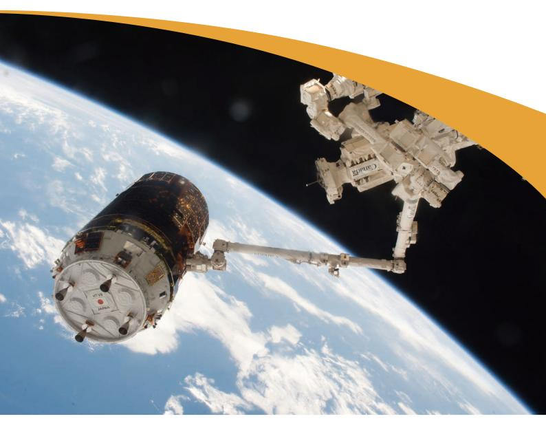
宇宙ステーション補給機「こうのとり」(HTV:H-II Transfer Vehicle)は、国際宇宙ステーション(ISS)への食料や実験 装置・実験試料などの補給物資を運ぶために日本が開発し、 運用している無人の宇宙船です。
